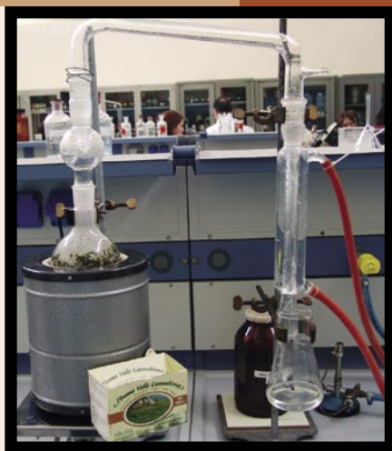
Distillatore a pallone, usato per la determinazione degli oli essenziali della Tisana Val Cannobina, presso il Laboratorio di Analisi dell'Istituto Galletti di Domodossola.
